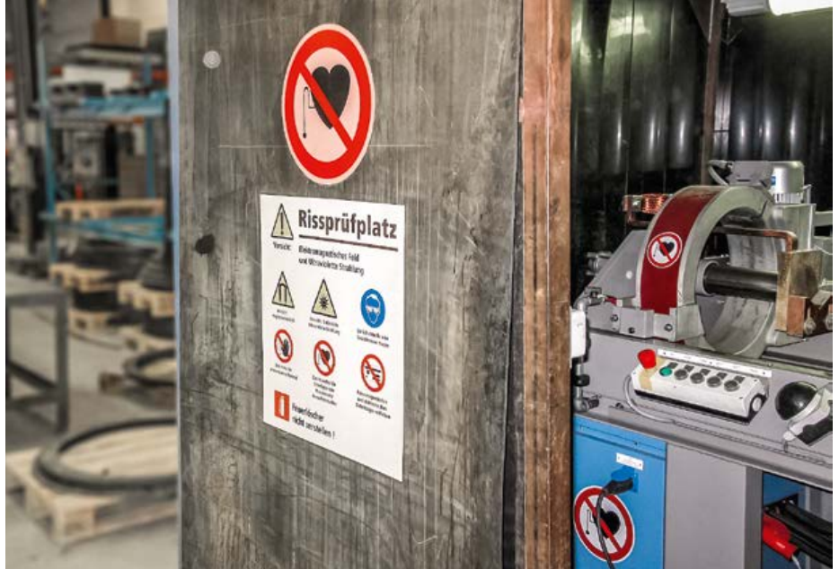
Starke Gleichströme bei der Magnetprüfung oder im Unterwerk verursachen hohe statische Magnetfelder.
