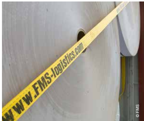
Das Schadenrisiko beim Containertransport von Papierrollen wurde mit dem patentierten JuStIn-System deutlich entschärft
