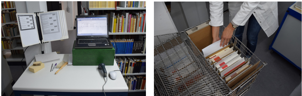
Abb. 5 und 6: Der mobile Arbeitsplatz des Projektes Mengenentsäuerung (linke Abbildung) und Verpackung entsäuerungsfähiger Bände in einen Behandlungskorb (rechte Abbildung). Fotos: Melanie Kubitzka, DLA
