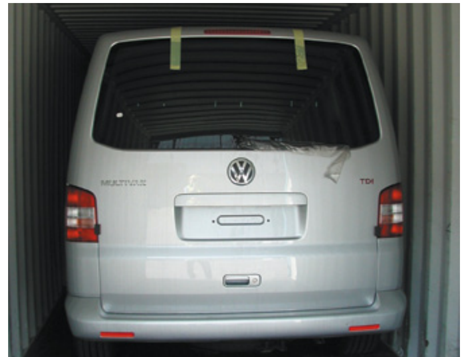
Kleinbus, geladen in einen Standard-Container, noch nicht gelascht
