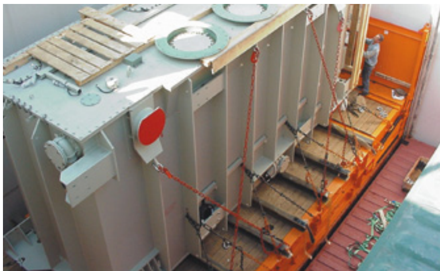
Dieser Transformator mit einem Gewicht von etwa 160 Tonnen wurde auf Stahlträgern gelagert und mit Ketten gelascht
