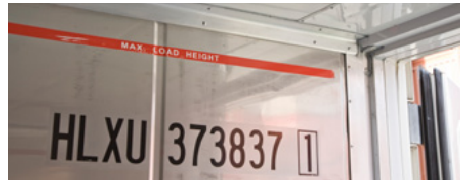
Die maximale Ladungshöhe ist durch eine rote Linie markiert
