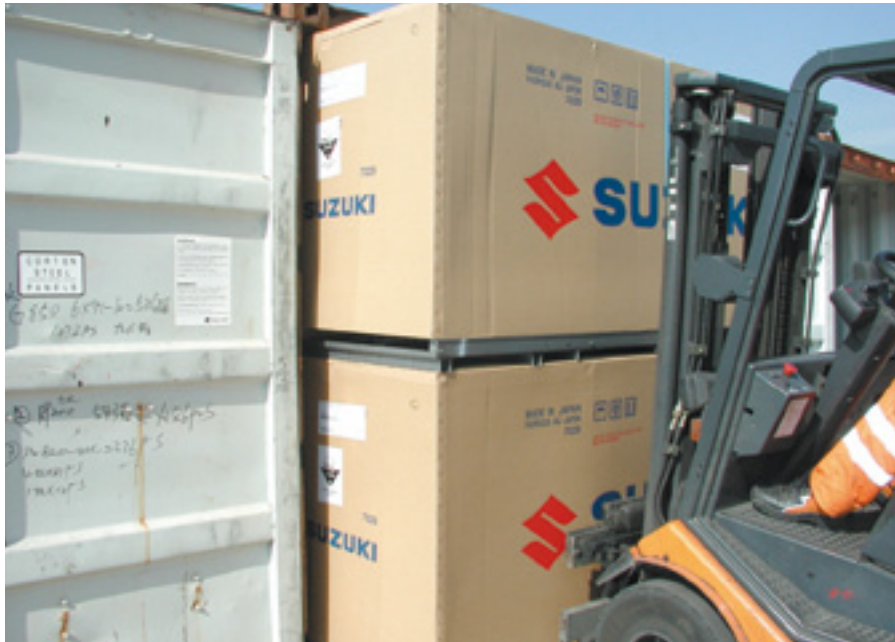
Größe und Struktur der Verpackung der Motorräder sind auf die Abmaße des Containers abgestimmt
