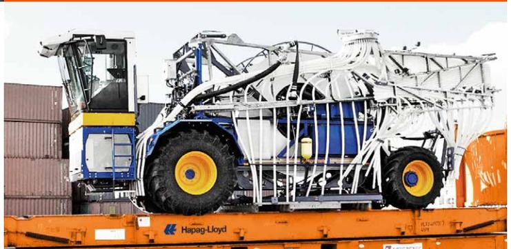
Landmaschinen für China: Pre-lashed ging dieser 13 Tonnen schwere Gülleausbringer in Dänemark an Bord, per Feeder zunächst nach Hamburg, Deutschland, und dann weiter auf einem der Mainliner von Hapag-Lloyd. Mit 11 x 3,4 x 4 Meter ist solch eine Ladung fast schon Alltag, gerade auf den Liniendiensten Richtung Asien.
