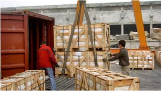
Container. Spezielle Holzboxen schützen die Steine und den Transportbehälter.
