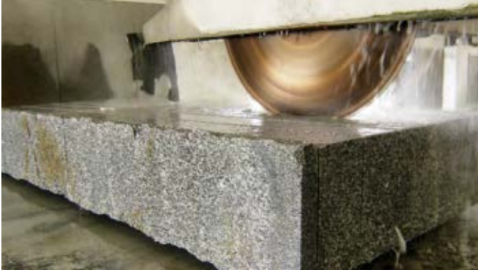
Bearbeitung. Mit wassergekühlten Sägen werden die Natursteine zerteilt.
