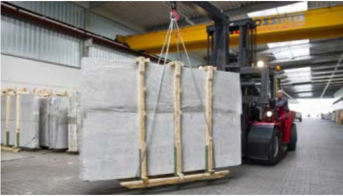
Patentlösung. Die Rohplatten sind auf hölzernen Spezialschlitten fixiert.
