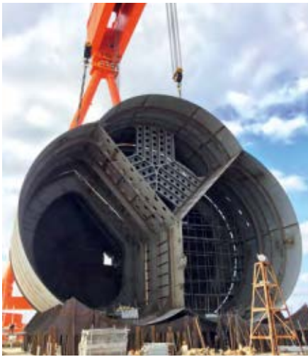
Gigant. Die „Star-Trilobe“-Tanks haben die Form dreier ineinandergeschobener Zylinder. Das Volumen jedes der 27 Meter hohen und 40 Meter langen 85k-Tanks beträgt mehr als 23.000 m 3 .
