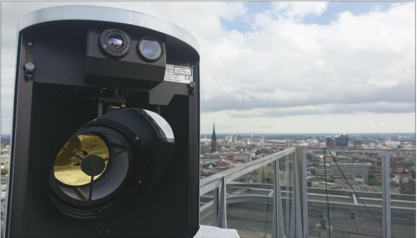
Fernerkundung: Mit dem Scannenden Infrarot-Gasvisualisierungssystem (SIGIS) der Analytischen Task Force (ATF) hätten unbekannte, gasförmige Stoffe identifiziert, quantifiziert und visualisiert werden können
