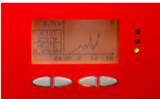
Der Umwandler: Ein Wechselrichter wandelt den Gleichstrom der Photovoltaik-Module in Wechselstrom um, der genutzt werden kann.
