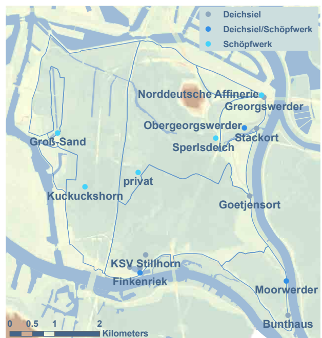
Abb. 22: Deichsiele und Schöpfwerke in den Gemarkungen Wilhelmsburg und Moorwerder (Datengrundlage: Amt für Wasserwirtschaft, 1998; eigene Darstellung).
