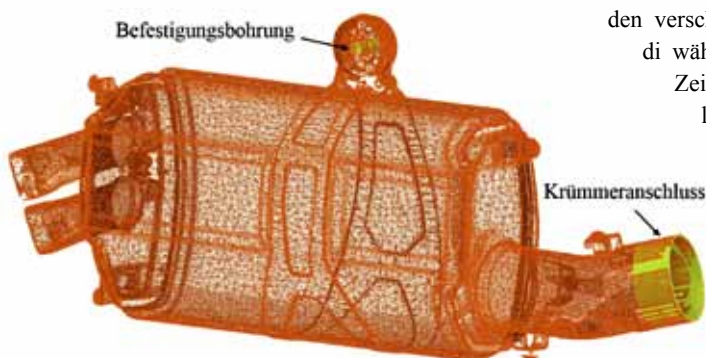
CAD-Flächenmodell des Serienschalldämpfers mit gelben Volumenelementen für den Bereich des Krümmeranschlusses und der Befestigungsbohrung
