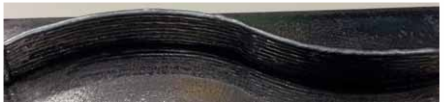
Additiv gefertigte Komponenten mit Hilfe des Laser-Pulver-Auftragschweißens
