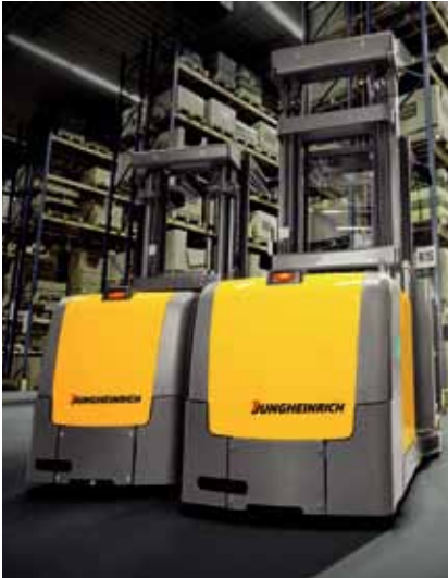
Elektro-Vertikalkommissionierer EKS 210 und EKS 312
