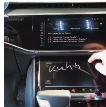
Das Ziel einfach aufschreiben: Über den Touchscreen wird der darüber platzierte große Bildschirm mit dem Navigationssystem gesteuert.
