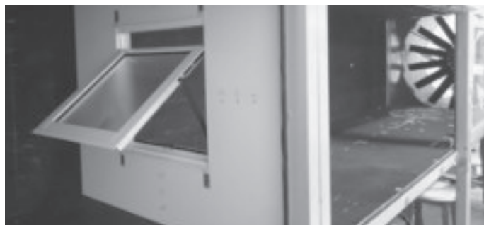
Abb. 3 Fenster und Drucksensoren, installiert im Windkanal
