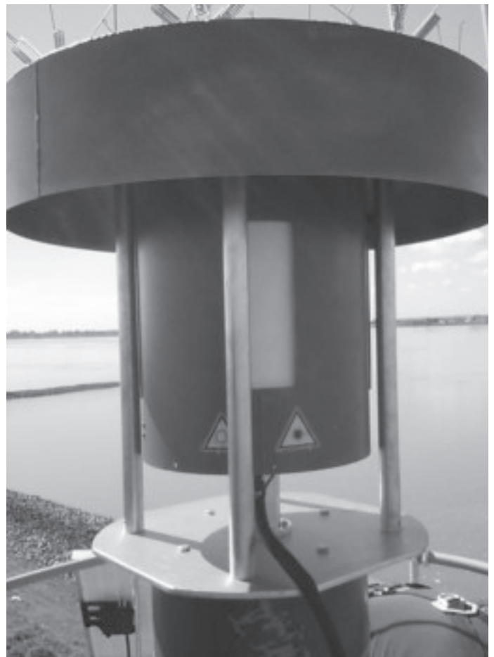
Abb. 2 Doppelzylinder als Gehäuse für das Messsystem
