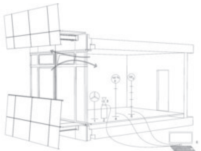
Abb. 1 Aufbau für Luftwechsellmessungen mit SF6 Tracergas an der HCU
