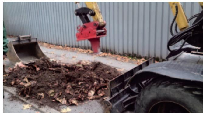
Die Original-Wurzelratte ist ein BaggerAnbauwerkzeug, gefertigt aus Spezialstahl und konstruiert für den jahrelangen Einsatz. (Foto: Wurotec GmbH & Co. KG)
