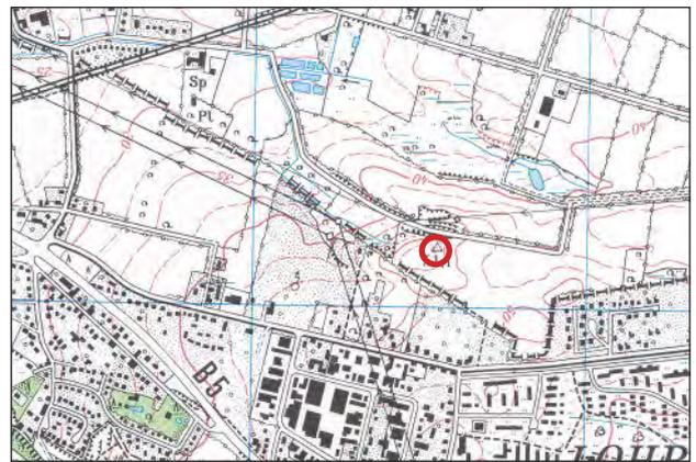
TP Havighorst, um 1968. Durch Kiesabbau verschwand der TP-Pfeiler; er wurde später ca. 6 m tiefer von den alten Sicherungsplatten ausgehend wieder hergestellt.
