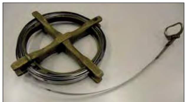
Abbildung 11: Beispiel eines 20-Meter-Stahlbandes
