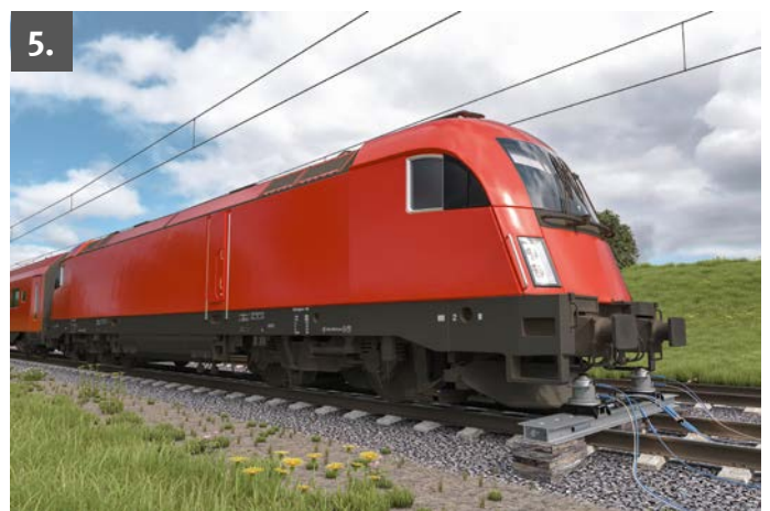
Die Lokomotive wird abgesenkt und eingeleist.
