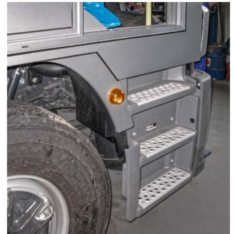
Der sichere Zugang zur Kabine muss ohne Hilfsmittel möglich sein.
