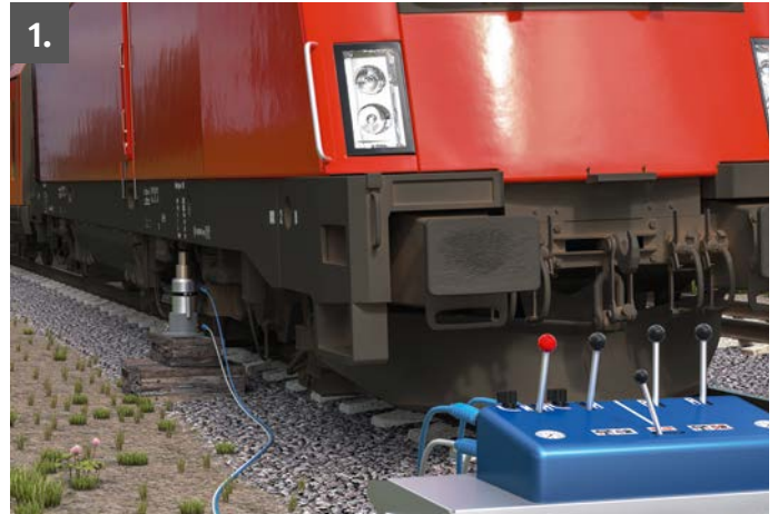
Zwei Zylinder heben die Lok und richten sie waagrecht aus.
