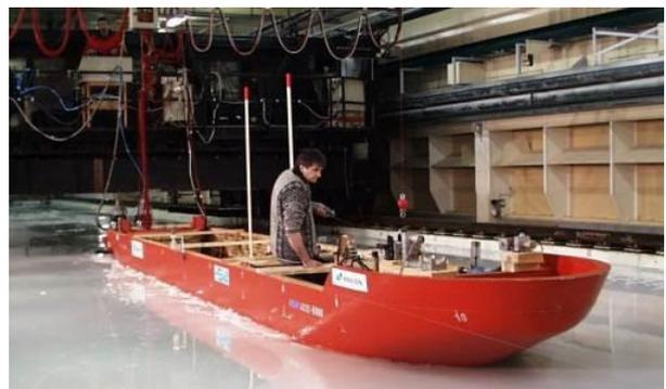
*Ein Schiffmodell im Eiskanal*
