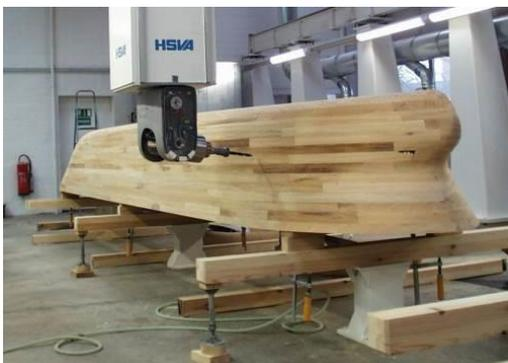
*Fertigung eines Schiffsmodells mit der Computer-gesteuerten Fräse*
