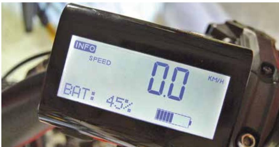
Am Display lässt sich die Fahrstufe für die Unterstützung einstellen sowie der Ladezustand des Akkus ablesen.
