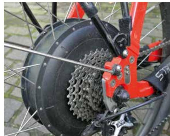
Die 500-Watt-E-Power wird auf das Hinterrad übertragen.
