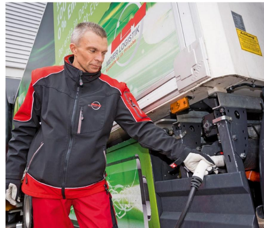
Die Reichweite der Elektro-Lkw beträgt etwa 250 Kilometer, in nur sechs Stunden lassen sich die Batterien vollständig aufladen.
