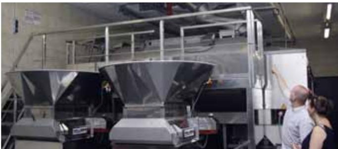
Im Kelterhaus werden die Trauben mit wenig Druck gequetscht und laufen durch Rohre in den Kelter. Das Ergebnis ist der sogenannte Most. Jede mechanische Belastung schadet dem Most und somit dem Wein, deshalb wird auf Pumpen verzichtet. Je langsamer und schonender der Wein vergärt,
