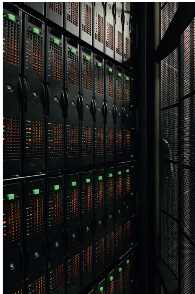
Mistrals bullx-Rechnerknoten mit je zwei Intel 12-Kern-Haswell-Prozessoren: Im Endausbau stehen den Klimaforschern etwa 100.000 Prozessorkerne zur Verfügung – dies ergibt eine Leistungssteigerung um den Faktor 20 im Vergleich zur Blizzard.
