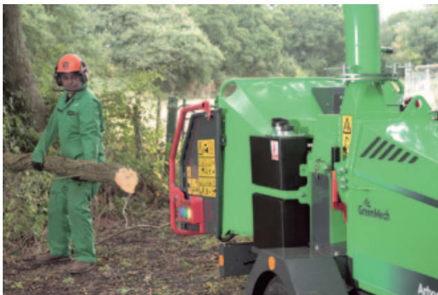
Bild oben: Gut zu erkennen: Die beiden Schalter für Vor- und Rückwärtslauf neben dem Sicherheitsbügel: Zwangspausen durch verklemmtes Material gibt es nicht. Bild unten: Zuverlässig und ausdauernd verarbeitet der neue Arborist 200 von GreenMech Grünschnitt mit bis zu 200 mm Stammdurchmesser. (Fotos: Greenmech Ltd.)
