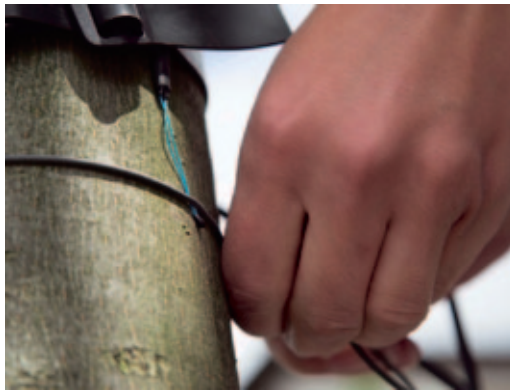
Gerade einmal stecknadelgroß sind die Sensoren, die der osteuropäischen Silberlinde ihre Geheimnisse in Sachen Hitzestressresistenz entlocken sollen. Insgesamt wurden für den Pilotversuch rund 50 Meter Kabel verlegt.
