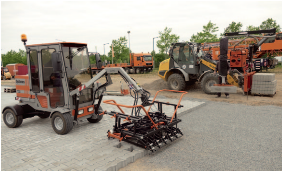
Die Optimas Pflasterverlegemaschine T 22 und der Optimas Vacu-Lift machen die Verlegearbeiten deutlich leichter und damit erheblich schneller. (Foto: Optimas GmbH)
