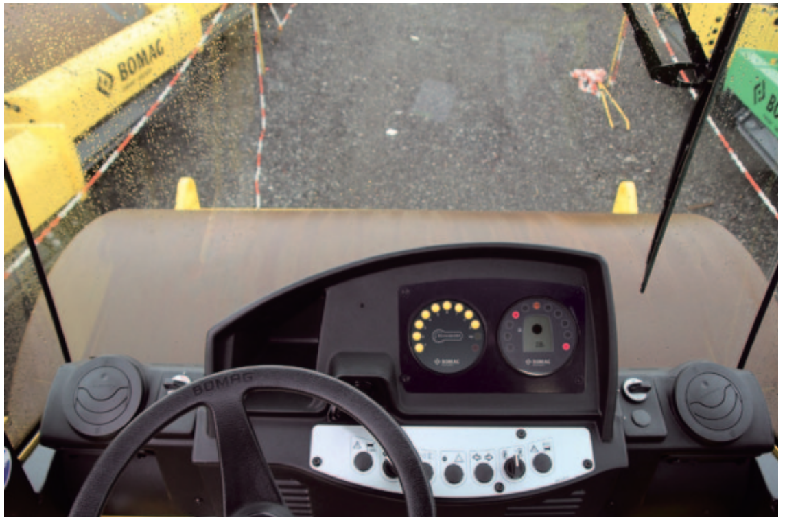
Der Economizer von Bomag misst den Verdichtungsgrad und zeigt ihn leicht verständlich an. (Foto: BOMAG GmbH)
