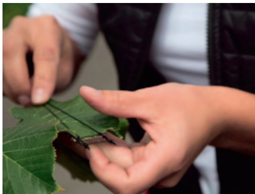
Das einladende Blätterdach sorgt für Abkühlung bei den Passanten, fängt dafür aber den Großteil der Sonneneinstrahlung ab. An drei ausgewählten Blättern wird daher der Temperaturverlauf mit filigranen Fühlern in der Baumkrone gemessen.
