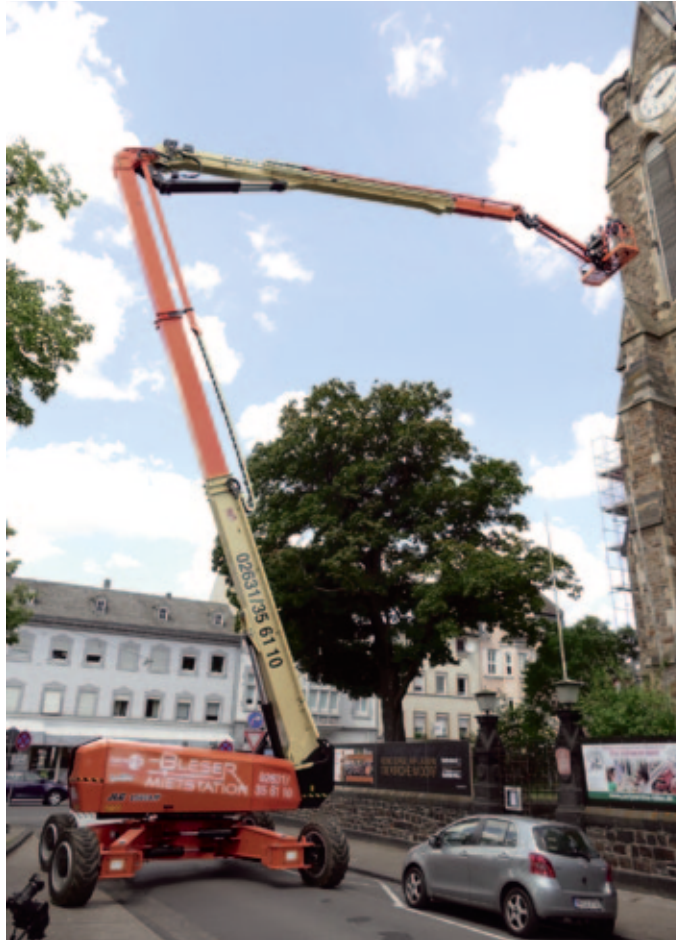
Mit 48,15m Arbeitshöhe und einer seitlichen Arbeitsreichweite von 23,55 m ist die JLG 1500AJP Gelenkteleskopbühne für viele Aufgaben einsetzbar. (Foto: JLG Deutschland GmbH)
