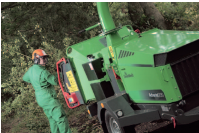
Bild oben: Gut zu erkennen: Die beiden Schalter für Vor- und Rückwärtslauf neben dem Sicherheitsbügel: Zwangspausen durch verklemmtes Material gibt es nicht. Bild unten: Zuverlässig und ausdauernd verarbeitet der neue Arborist 200 von GreenMech Grünschnitt mit bis zu 200 mm Stammdurchmesser. (Fotos: Greenmech Ltd.)
