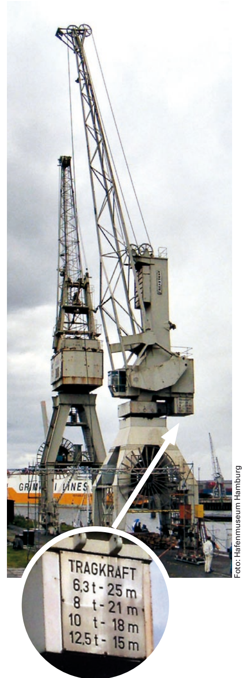
Bild oben: Zwei Portalkrane auf dem Freigelände des Hafenmuseums: Im Hintergrund der Peiner-Kran mit einer Tragkraft von max. 25 t, im Vordergrund der Kampnagel-Kran mit einer Tragkraft von max. 12,5 t. Im Kreis: Das Tragkraftschild am Kampnagel-Kran informiert den Kranführer über Auslegerweiten und deren Höchstlasten.
