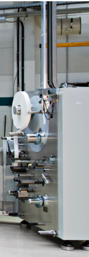
Die Hauni-Lösung SMOS eignet sich für alle Zigarettenmaschinen ab Baujahr 2005, zum Beispiel die PROTOS-M4.
