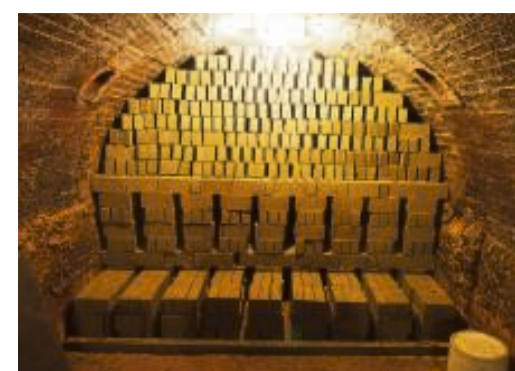
OBEN: Blick in den Ofen – Die geformten Ziegel sind für den Brand vorbereitet. UNTEN: Premiere – Matthias Rusch zeigt die ersten Riemchen.
