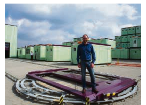
Stephan Lux ist Technischer Leiter bei AMTRA in Dernbach. Er entwickelt unter anderem Container-Konzepte und leitet auch den technischen Einkauf. Hier steht er auf einem AMTRA-Drehkreuz für Container. Die werden hier gedreht und zur Aufbereitung in die Halle gerollt.
