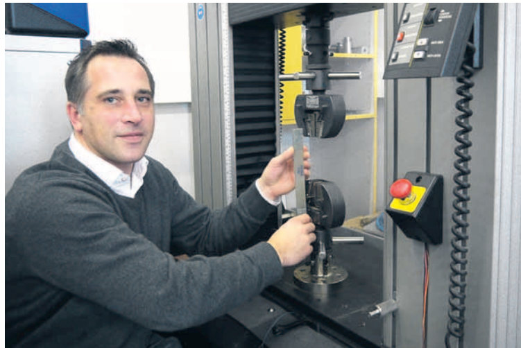
Projektleiter Leif Ole Meyer an einer Universalprüfmaschine, mit der etwa Werkstücke aus Epoxidharz auf Herz und Nieren getestet werden.
