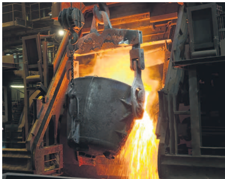
In der Rohhütte wird das flüssige Kupfer in Konverter gegossen.
