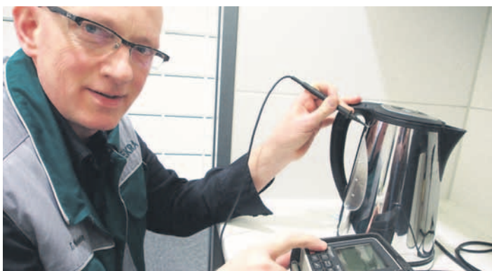
Wehe, der Wasserkocher hat einen Kurzschluss: Ortsveränderliche Elektrogeräte in Unternehmen müssen regelmäßig auf ihre Funktionsfähigkeit überprüft werden, wie Thomas Wedeking hier demonstriert.
