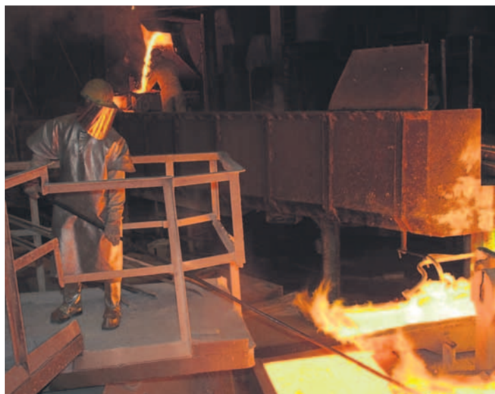
Am Anodengießbad wird das flüssige Kupfer in die Anodenform gegossen. Der Kupfergehalt liegt hier schon bei 99,5 Prozent.
