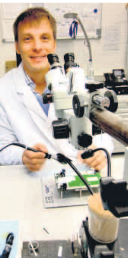
Im hit-Technopark: Entwicklungsingenieur und Standortleiter Tobias Schmidt bestückt im Elster-Labor eine Platine mit Analyse-Komponenten.
