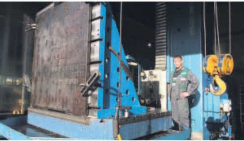
Auf dem Bohrwerk können bis zu zwölf Tonnen schwere Werkstücke mit den Abmaßen von etwa zwei mal dreieinhalb Meter bearbeitet werden. Hier hat Daniel von Holten eine schwere Montageplatte aus Stahl eingespannt, die mit zahlreichen Bohrungen und Passungen versehen werden muss.
