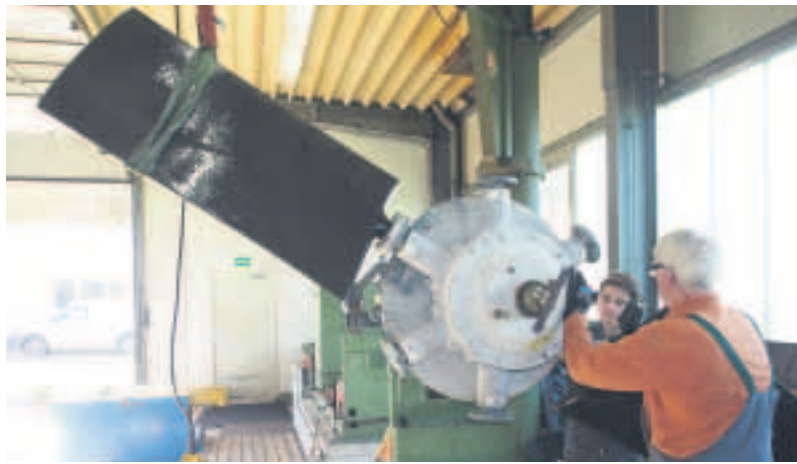
Zwei DMS-Mitarbeiter demontieren die Flügel eines riesigen Ventilators, der bei DMS repariert und ausgewuchtet werden soll.
