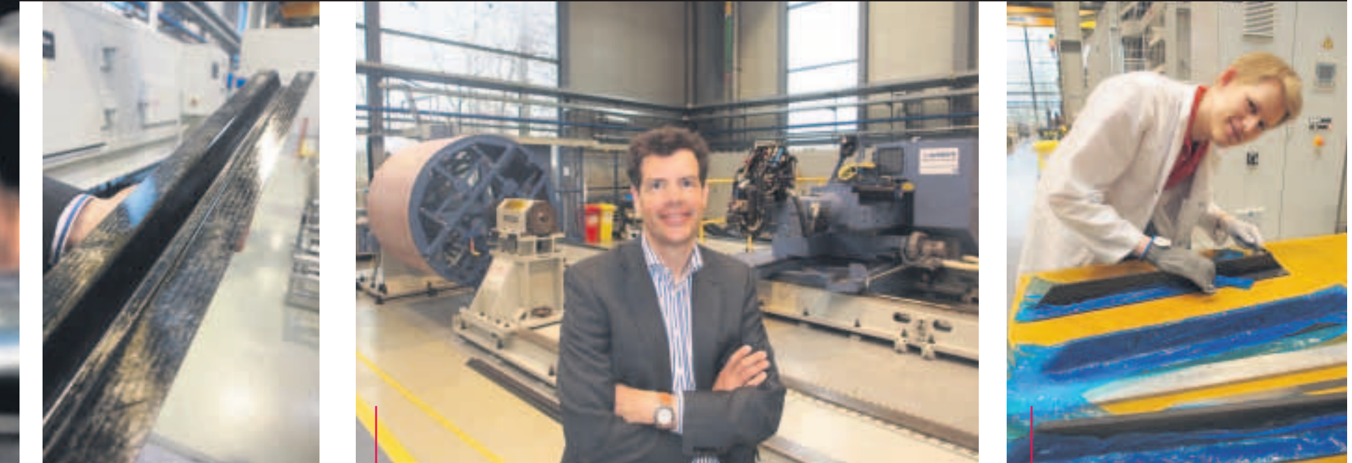
Für den Laien unspektakulär, in Wahrheit aber ein Hightech-Produkt: ein Bauteil, das aus Kohlefaserverbundwerkstoff hergestellt wurde. Eindrucksvolle Kulisse: Dr. Martin Röhrig steht in der CTC-Werkhalle vor einer Fiber Placement Anlage, einer Maschine, auf der unter anderem Testbauteile für Airbus gefertigt werden. Student Dominik Wessel bereitet sich auf den Bachelor-Abschluss an der TH Aachen vor. Hier in Stade baut er so genannte T-Stinger aus CFK. Fotos: Wolfgang Becker
