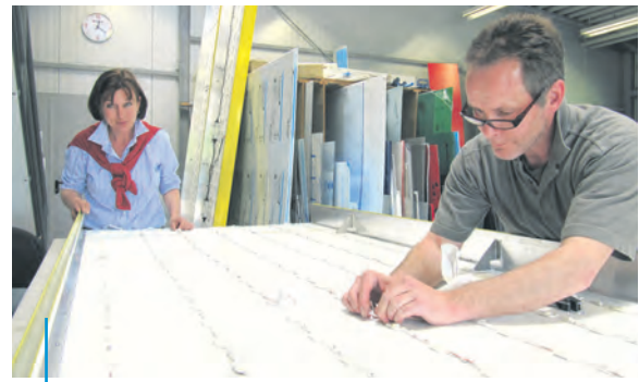
Hier wird es elektrisch: Lichtenlagen-Monteur Jürgen Schoedel montiert LED-Leuchten in einer großflächigen Werbeanlage für Edeka – fast 200 Stück auf jeder der vier Platten.
