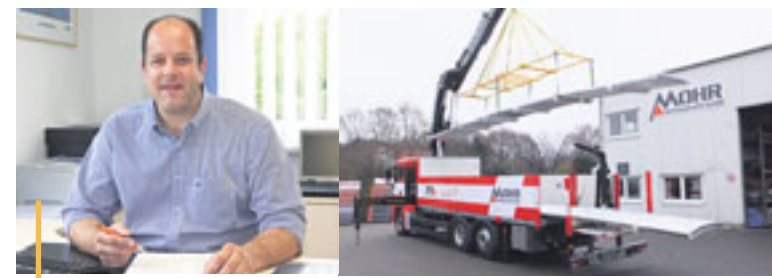
Geschäftsführer Steffen Mohr an seinem Schreibtisch. Rechts: Der Spezial-Lkw der Firma Mohr mit einer Ladung Stahl-Trapezbleche. Der Kran kann bei 16 Metern seitlicher Auslage noch Last von gut zweieinhalb Tonnen tragen, so dass die Ware am Bau auch direkt dort hingestellt werden kann, wo der Kunde sie haben möchte.
