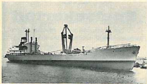
MS „Birkenfels“ — Bauwerft: AG-Weser, Bremen, Länge über alles: 152,23 m, Breite auf Spanten: 20,40 m, Tiefgang auf Sommerfreibord: 12,20 m, Tragfähigkeit: 12 553 t, Geschwindigkeit: 20,5 kn, Hauptantriebsanlage: MAN, Maschinenleistung: 11 200 Pse.
