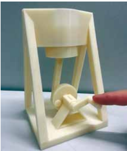
Beispielbauteil zur Untersuchung der notwendigen Spaltmaße
