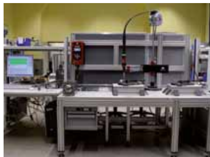
Prüfstand mit EC-Schraubspindel zur Aufnahme von Drehmomentsignaturen
