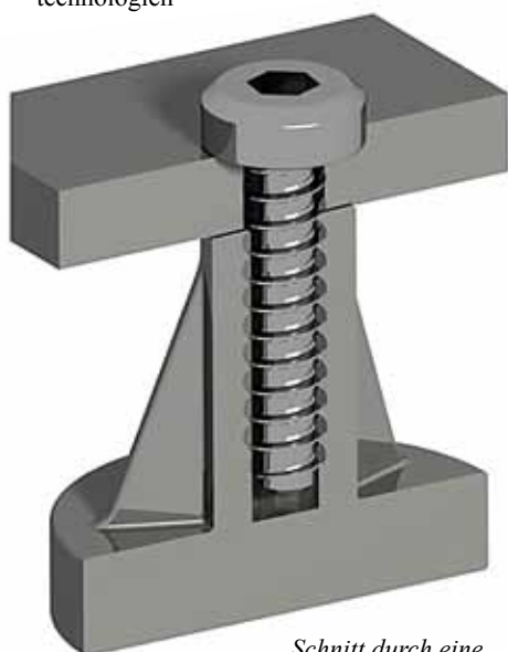
Schnitt durch eine direkt verschraubte Fügestelle
