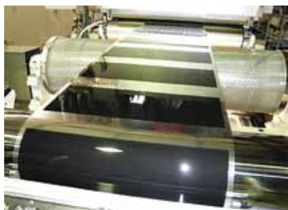
Versuche zur Intermittierenden Batterieelektrodenherstellung im Technology Center der Firma
