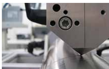
Bead Coat - Düsenauftragstechnologie zur Applikation von sehr dünnen Schichten
