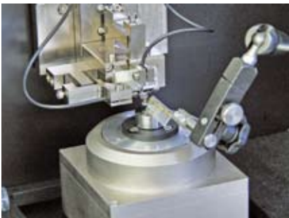
Nanotribometer für Reibungs- und Verschleißuntersuchungen
