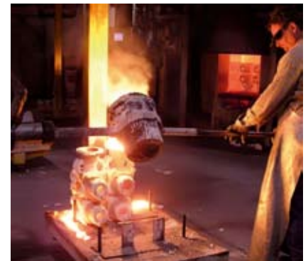
©Zollern GmbH & Co.KG - offener Stahl-Feinguss
