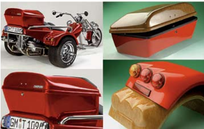
Bild 2: Herstellung von Kofferraumschale und Kotflügel des Trikes im PUR-Faser-sprühverfahren
