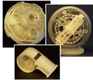
Die prämierten Modelle: Schaltbares, dreistufiges Planetengetriebe, Trillerpfeife und Triebstockgetriebe
