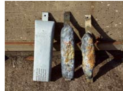
So fleißig ist die Korrosion. Verbrauchte Zink-Anoden im Vergleich mit einer neuen (links)
