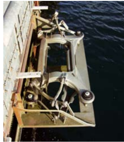
Dieser Achsenträger eines Mercedes ist schon ca. 10 Jahre der Meereskorrosion ausgesetzt.
