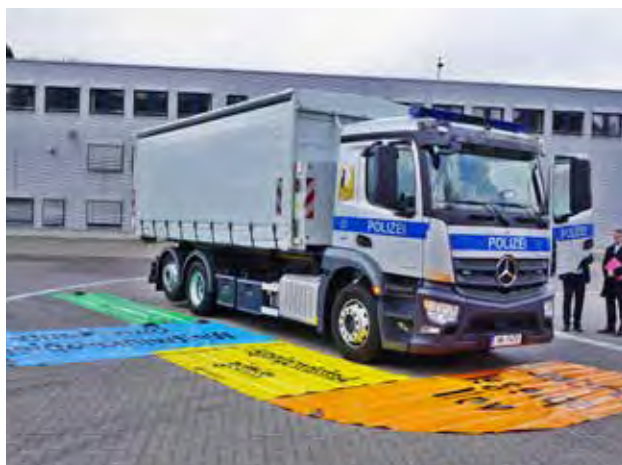
Planen markieren die Bereiche, die von den Außenspiegeln eines Lkws erfasst werden. Lkw-Fahrer bei der Polizei Hamburg werden eingehend zum "Toten Winkel" und dem richtigen Einsatz der Außenspiegel beschult.
