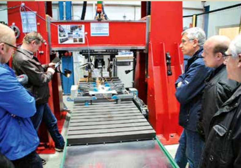
Praktische Vorführungen veranschaulichten die theoretischen Ausführungen zu den verschiedenen Füge- und Schweißverfahren. Im Bild ein Rührreißschweißgerät im Einsatz.
