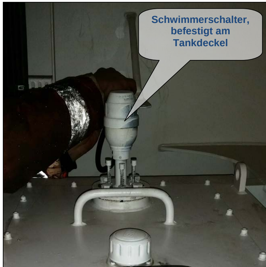
Abbildung 19: Hydrauliköl-Tankdeckel mit Schwimmerschalter
