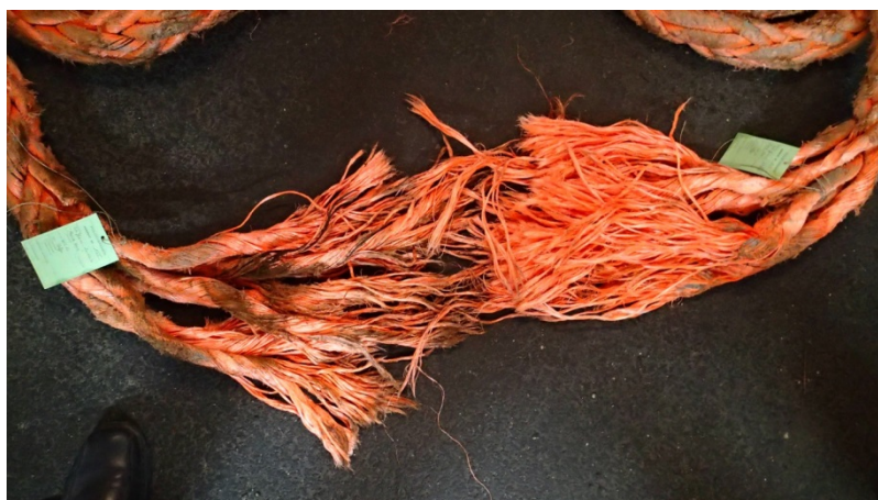
Abbildung 6: Bruchstelle der Leine
