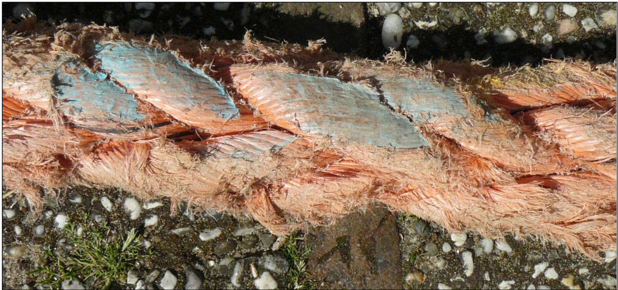
Abbildung 15: Farbabrieb von einer Klüse
