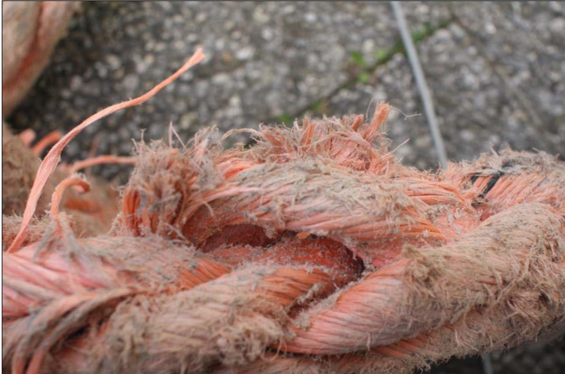
Abbildung 12: teilweise schwere Abnutzung
