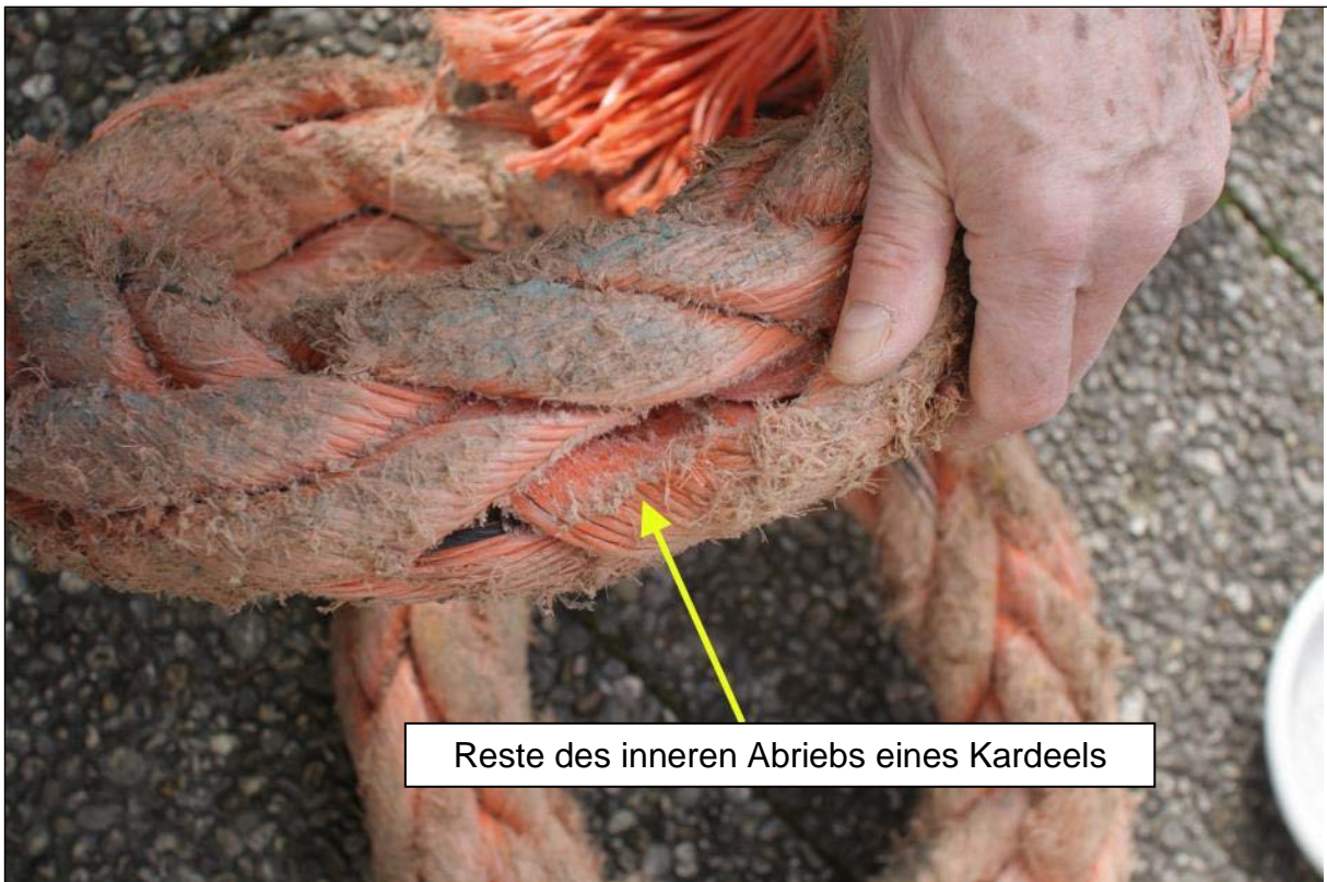
Abbildung 14: Innenstrangabrieb durch regelmäßige Abnutzung
