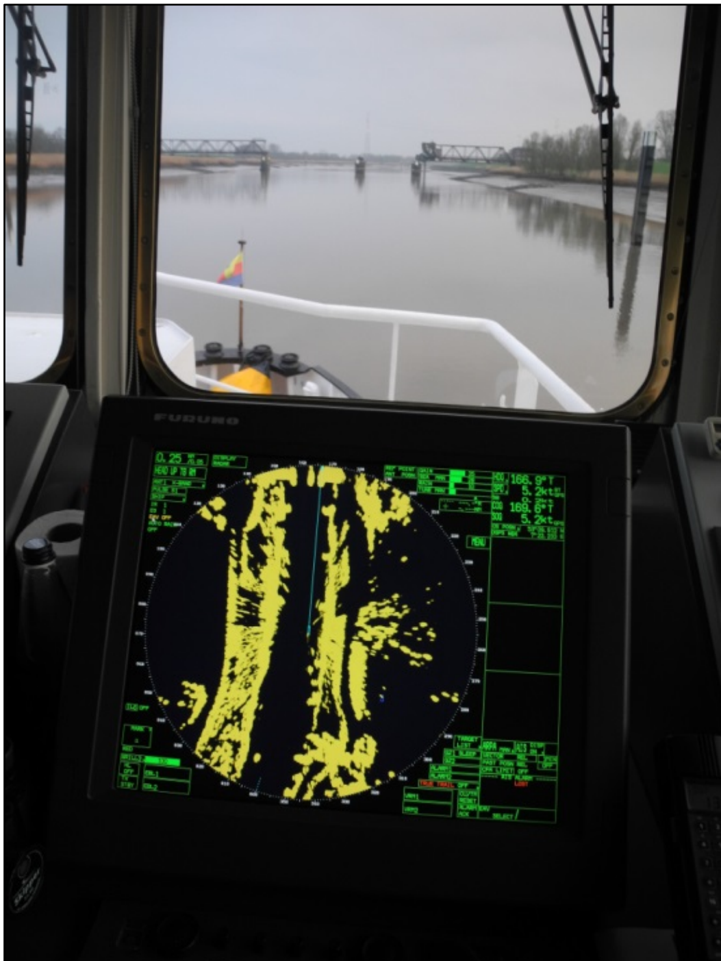
Abbildung 22: 0,25 sm Bereich Friesenbrücke, beide Durchfahrten zu sehen
