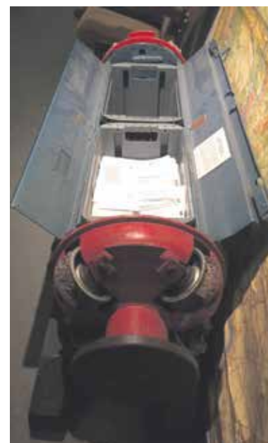
Solche „Briefbomben“ (links) flitzten durch Rohre unter der Altstadt. Über Öffnungen (rechts) konnte man Kondenswasser aus der Anlage entfernen
