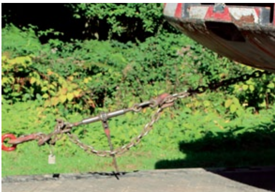
(Ratschlastspanner im Einsatz) Teile der Fachwelt behaupten, dass die immanente Selbsthemmung der Ratschlastspanner nicht ausreichend ist, um ein Losdrehen effektiv zu verhindern.
