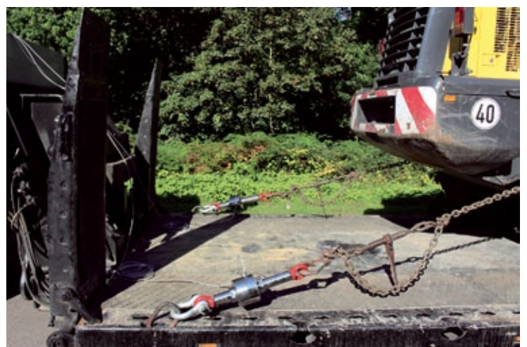
(Verzurrung am Heck des Radladers) Kraftmessdosen mit einem Messbereich von 200 kN ermöglichen die permanente Aufzeichnung der in den Zurrketten wirkenden Kräfte.
