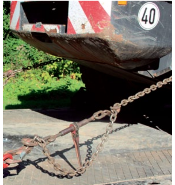
(Zurrkette im Einsatz) Zurrketten finden in der Schwerlast- und Baubranche häufig Anwendung.
