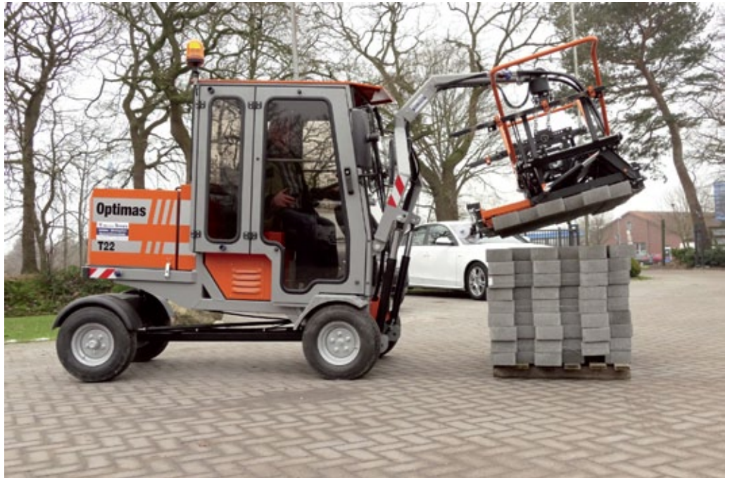
Die neue Optimas T 22 Pflasterverlegemaschine ist für mittlere Einsatzgrößen gedacht. Bei der Firma Matthias Sassen wird sie bereits erfolgreich genutzt. (Foto: Optimas GmbH)
