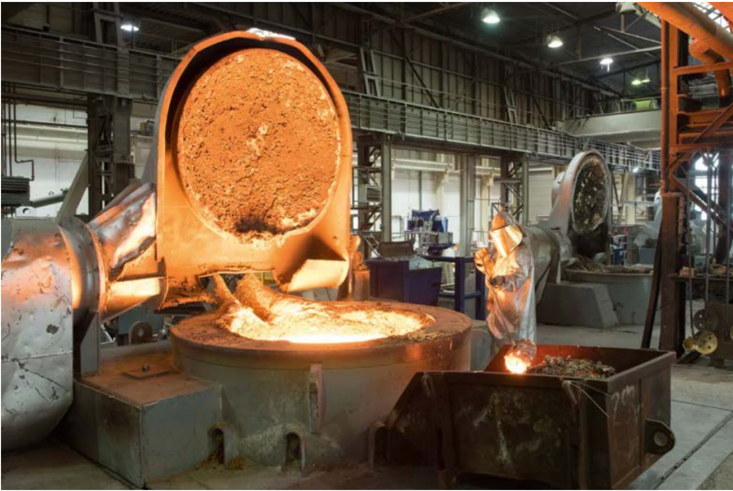
Feuerbad. Die Kupferlegierung ist bis zu 1.200 Grad heiß. Etwa 12 bis 15 Minuten dauert es, bis die Metalle zu einer glühenden Masse geworden sind.
