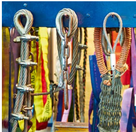
Sicherung. Seile mit Würgeklemmen helfen dabei, die Ware im Stauraum zu sichern.
