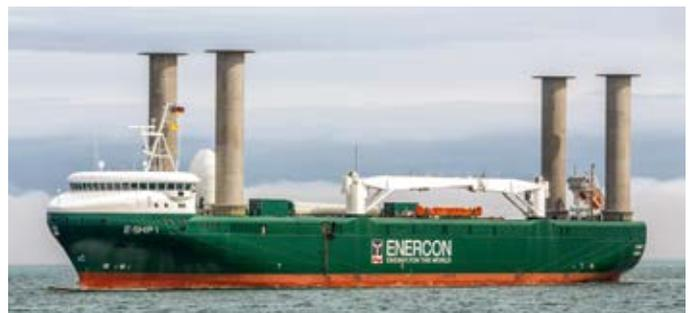
**Öko-Transporter.** Wie Schornsteine ragen die vier Flettner-Rotoren aus dem Rumpf des „E-Ship 1“. Die bewährte Technik spart bis zu 15 Prozent Treibstoff.
