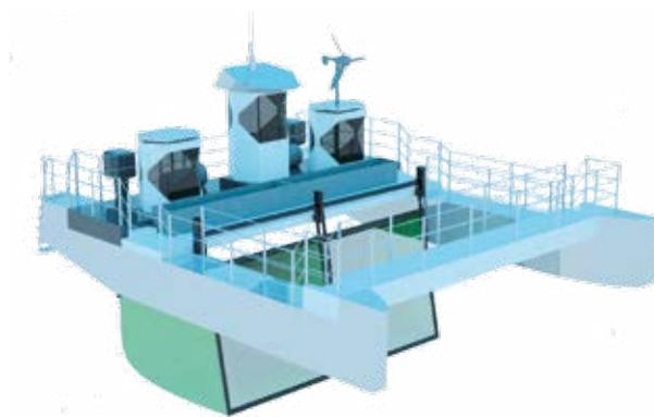
**Innovation.** Zwischen den jeweils zwölf Meter langen Rümpfen der „Seekuh“ fischt eine bewegliche Netzkonstruktion Müll, der an der Wasseroberfläche treibt.
