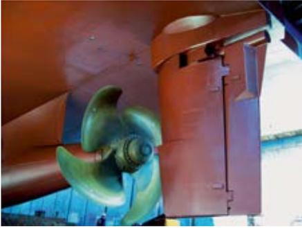
**Kraftvoll.** Das „TLKSR Twisted“-Ruder eignet sich besonders für Containerschiffe und Ro/Pax-Fähren.
