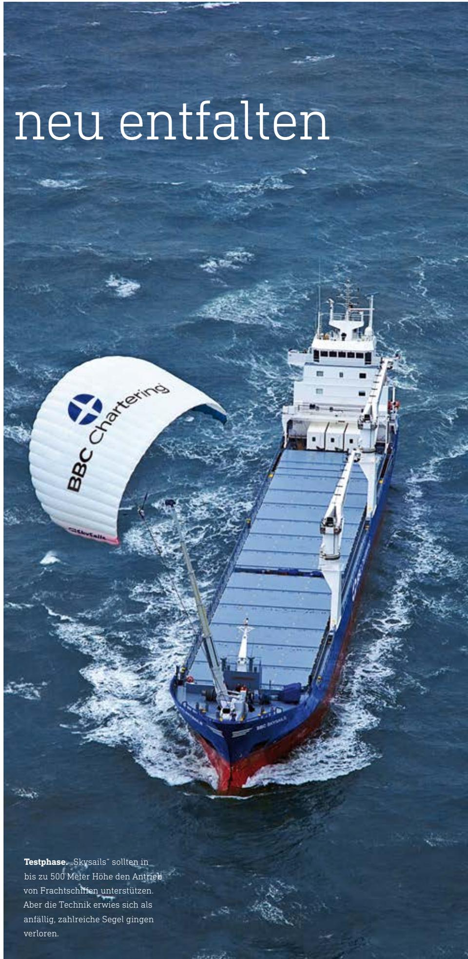
**Testphase.** „Skysails“ sollten in bis zu 500 Meter Höhe den Antrieb von Frachtschiffen unterstützen. Aber die Technik erwies sich als anfällig, zahlreiche Segel gingen verloren.
