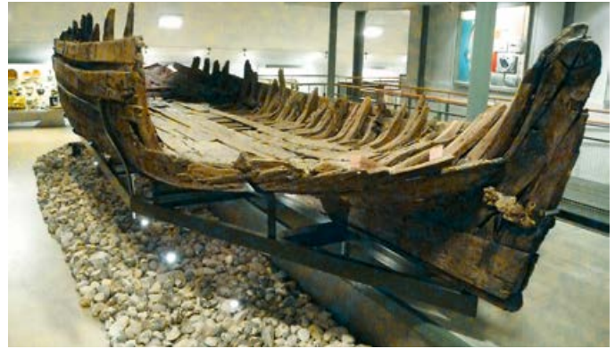
Highlight. Der jahrhundertealte Eichenholzrumpf wurde mit Sirup stabilisiert.
