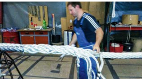
Kraftakt. Beim Spleißen werden die Seilstränge nach einem festen Muster miteinander verflochten.
