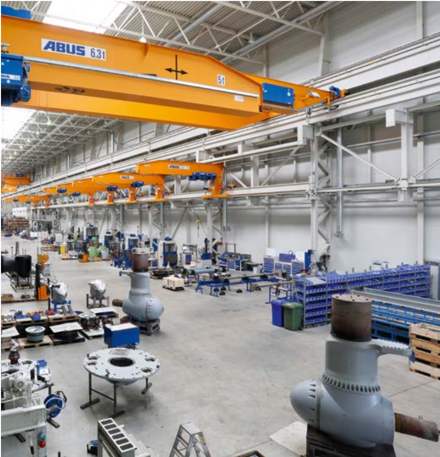
Stark. Dank neuer Maschinen kann Schottel alle wesentlichen Ruderpropellerbauteile selbst fertigen.
